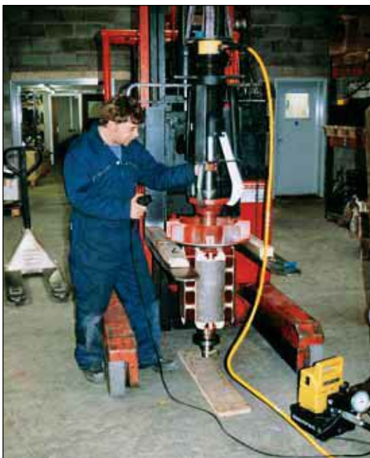
◀ El EPHR-116 utilizado para extraer poleas de motores eléctricos. El extractor se coloca en posición usando la placa de elevación.
